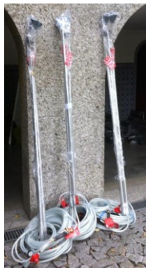
Imagem 15. Conjunto de varas e pormenor da ponteira com maçarico de gás propano
