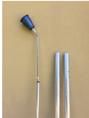
Imagem 15. Conjunto de varas e pormenor da ponteira com maçarico de gás propano
