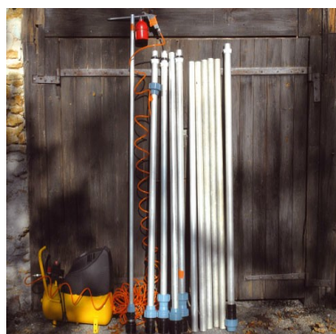
Imagem 21. Conjunto de varas interadaptáveis equipada com ponteira para aplicação de inseticida
