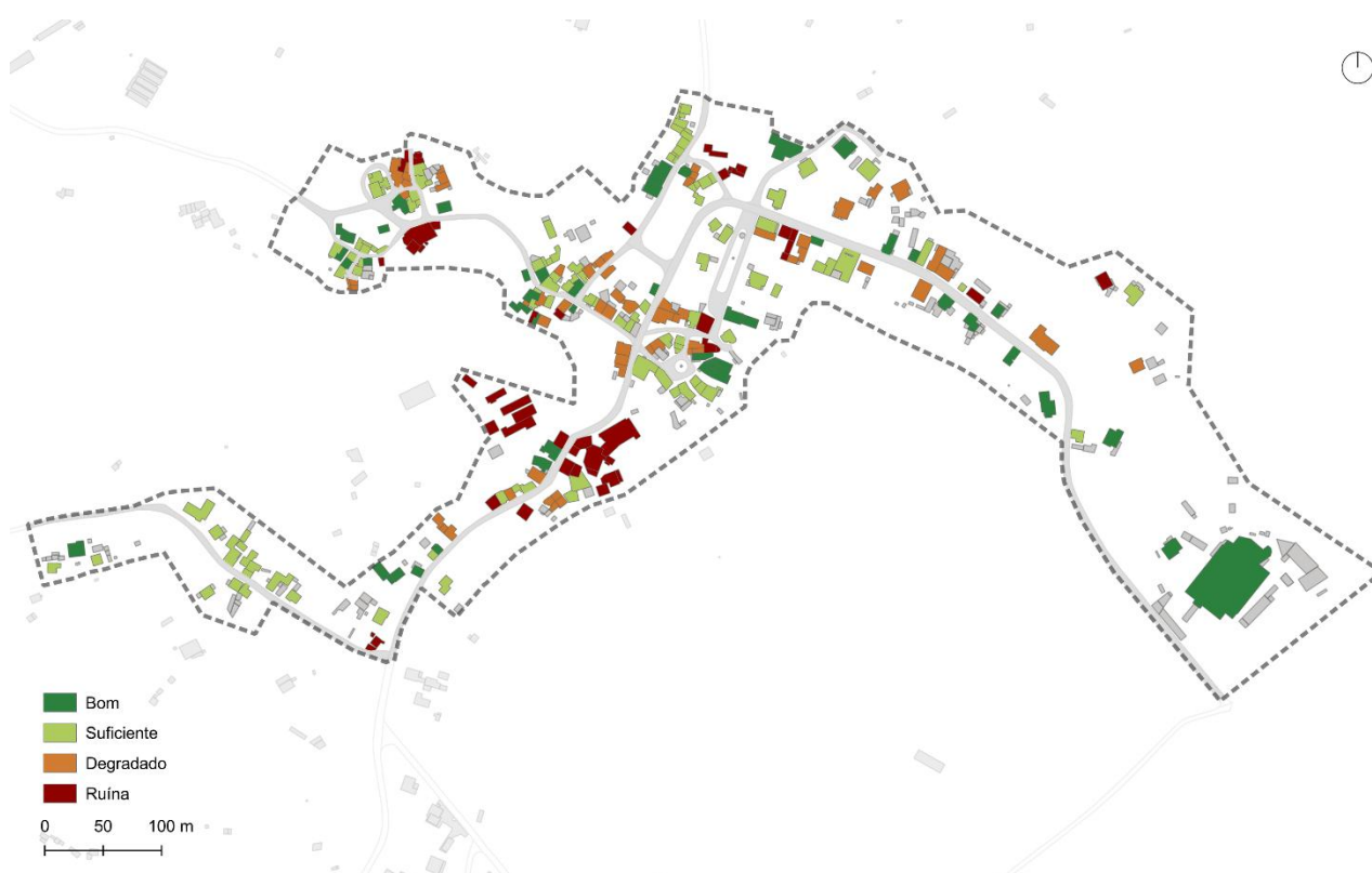
Figura 28. Planta do estado de conservação
