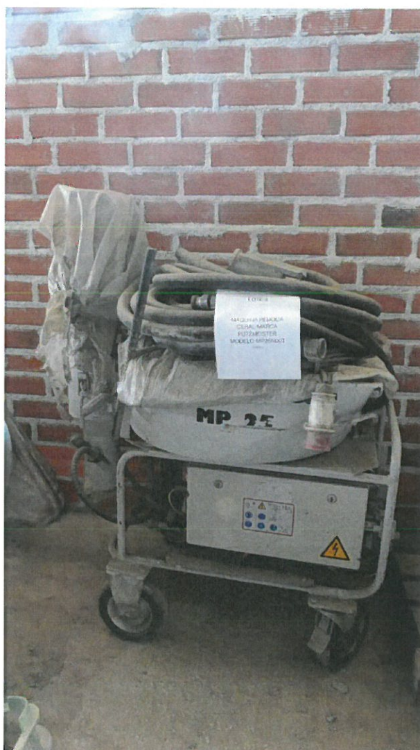
Figura 4- Lote 4: Máquina reboca ceral marca PUTZMEISTER modelo MP25NXIT
